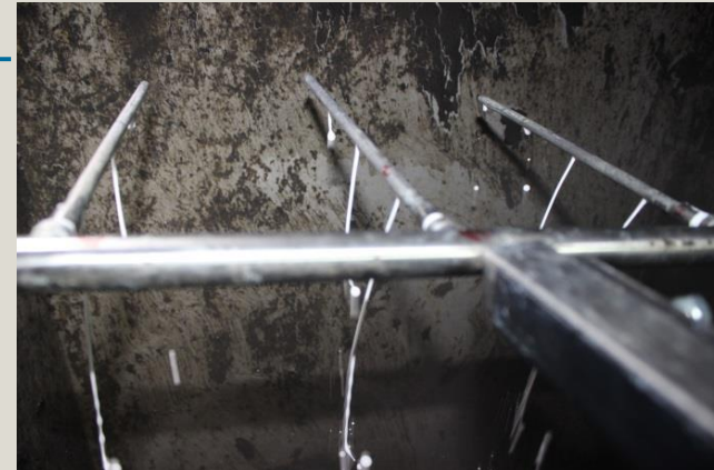
Dreizack zur Einbringung des nTiO 2
