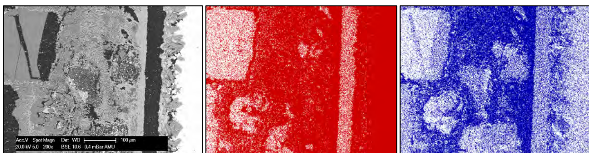
Abbildung 3: 15Mo3 Stahl+1g NaCl+0,1g Fe 2 O 3 (mixed), 600°C, 4h, [90,9% N 2 , 8,3% O 2 , 0,8% SO 2 ]
