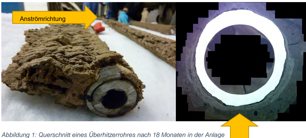
Abbildung 2: Überhitzerrohr mit Belagsbart [1]
