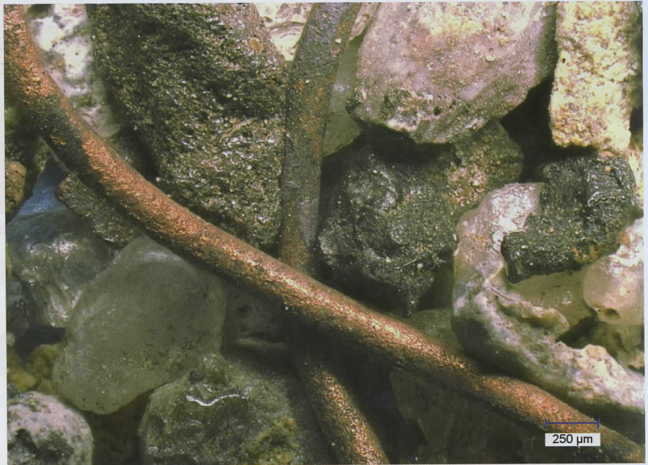
So sauber und unversehrt findet sich feiner Kupferdraht in aufbereiteter Schlacke aus Müllverbrennungsanlagen wieder.
