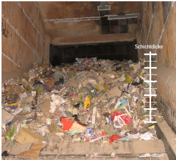
Abb. 3.1: Frischer, unverbrannter Müll unterhalb des Aufgabetisches (Schichthöhe maximal etwa 0,8 m bezogen auf die Randsteine)
