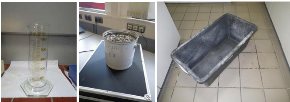
Abb. 2.1: Behälter zur Schüttdichte-Bestimmung (links: Glas-Messzylinder mit 0,5 l-Füllung; Mitte: Bleicheimer mit 2,75 l; Rechts: Wanne mit 65 l)
