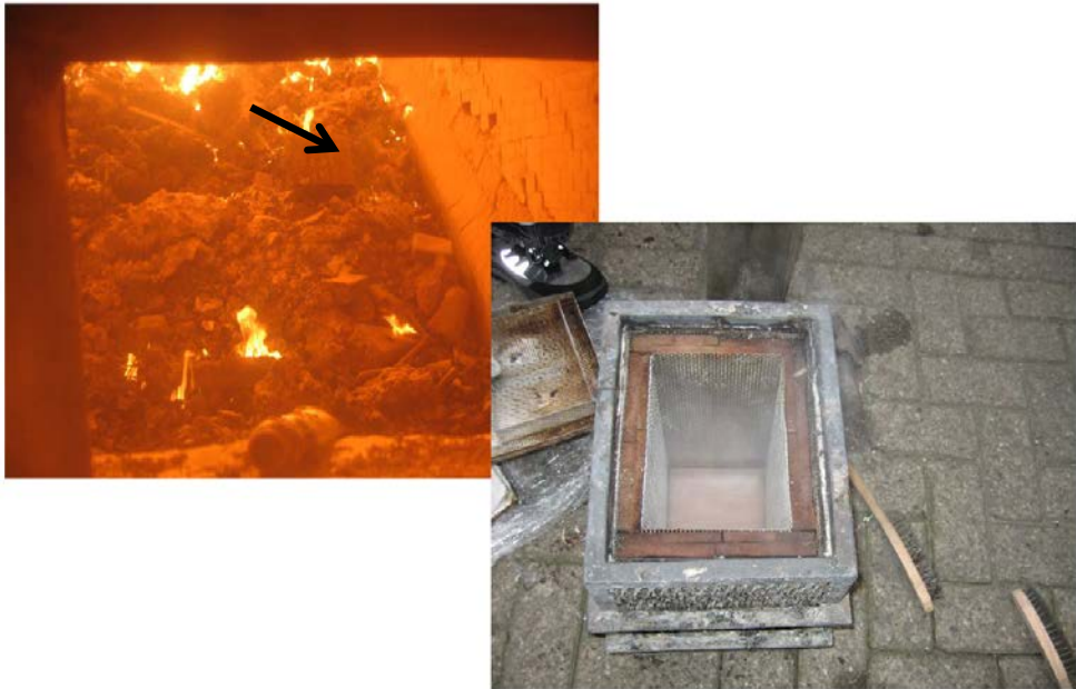
Abb. 5.4: Das „Ballinstrument“ auf dem Ausbrandrost (links) und nach dem Durchlauf durch die Feuerung (rechts)
