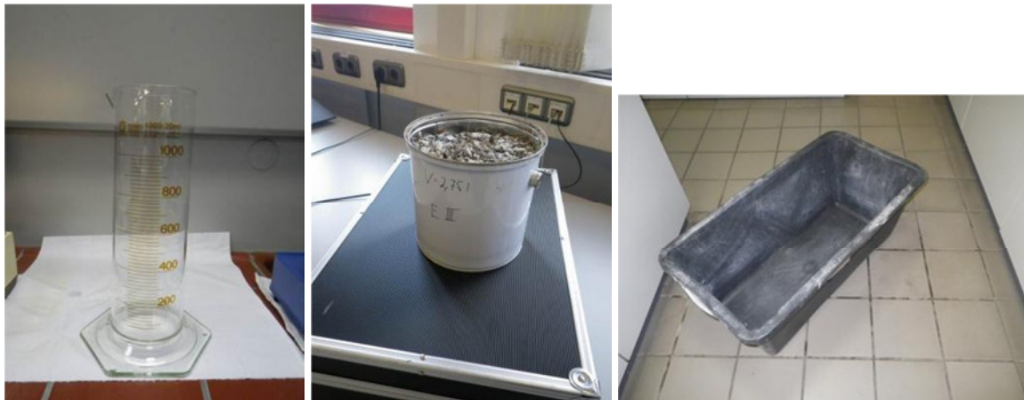
Abb. 2.1: Behälter zur Schüttdichte-Bestimmung (links: Glas-Messzylinder mit 0,5 l-Füllung; Mitte: Blecheimer mit 2,75 l; Rechts: Wanne mit 65 l)
