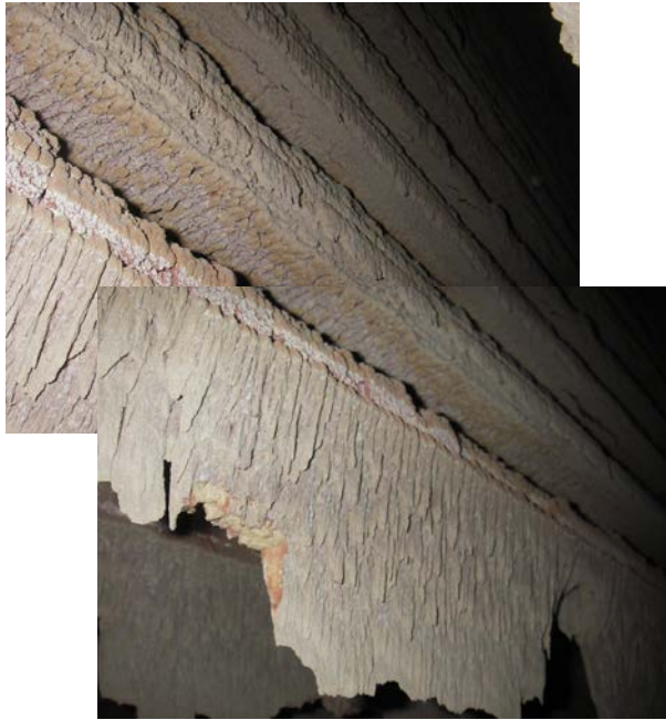
Abbildung 12: Reale Beläge eines Überhitzers am Ende der Reisezeit
