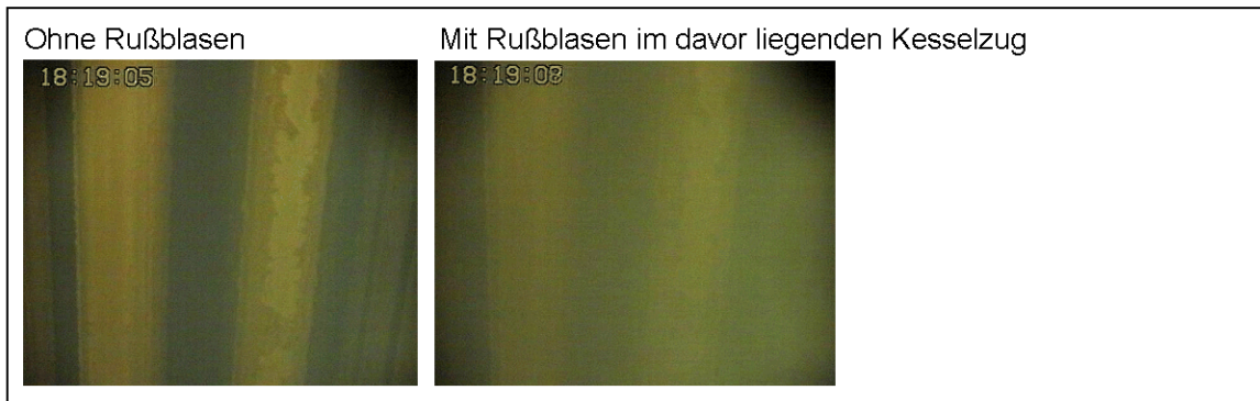
Abb. 9: Staubbeladung des Abgases im „Normalzustand“ und während des Rußblasens
