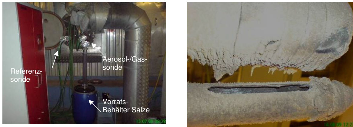
Abbildung 46: Aufbau zur Gas und Aerosoleindüsung und Referenzsonde (links), Aerosol/Gassonde und Lanze nach dem Ausbau (rechts)
