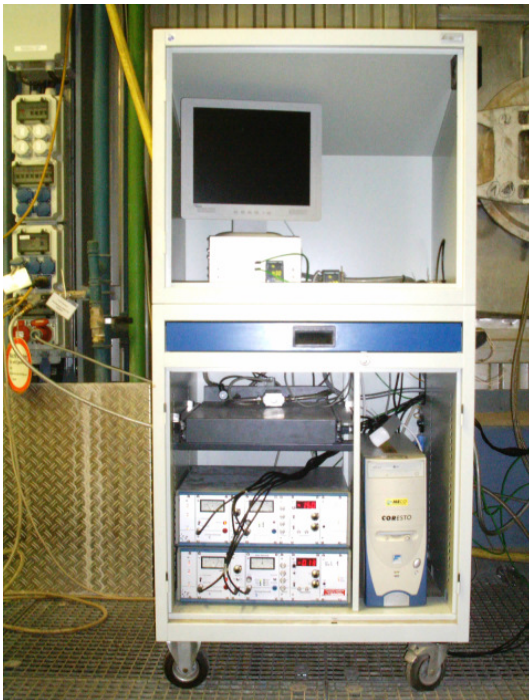
Abbildung 4-2 : Aufbau in der Anlage: im linken Bild der Schrank in dem die Messelektronik und der Messrechner untergebracht waren; rechts zwei Sonden in der Anlage eingebaut
