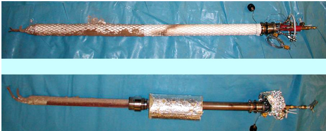
Abbildung 27: Probenahmesonden nach Einsatz im 1. und 2. Zug. Oben: Probenahmesonde nach Einsatz im 1. Zug. Zu sehen ist der keramische Isoliermantel aus Insulfrax, der nach jeder Messung erneuert wurde. Am Sondenkopf ist ein Schwanenhalskrümmer und ein Pitotrohr erkennbar. Unten: Probenahmesonde nach Einsatz im 2. Zug: Im 2. Zug kann ein 90°-Krümmer eingesetzt werden. Eine spezielle Isolierung gegen die Kesseltemperatur ist nicht notwendig. Zu sehen sind dagegen der Schraubflansch für die Fixierung der Sonde am Schaulukenschild und ein Steinwolle-Isolierrohr zur Isolierung im Kesselhaus.
