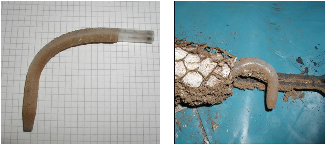
Abbildung 25: Quarzglaskrümmen nach dem Einsatz links: 90° Umlenk-Krümmen nach Einsatz im zweiten Zug. Zu erkennen sind fest haftende, harte Beläge. rechts: Schwanenhals-Einlasskrümmen nach Einsatz im 1. Zug. Außen anhaftend lockerer, grober Staub.
