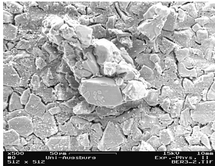
Abbildung 26: REM-Aufnahme des porösen Rohres. Mittig im Bild ist ein Splitter des Materials zu sehen, der beim Präparieren des Rohres entstand. Er zeigt den dreidimensionalen Aufbau des porösen Materials
