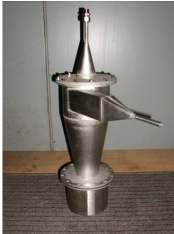
Abbildung 29: Zyklon des Probenahmesystems. Höhe über alles: ca. 635mm. Rechts: berechneter Trenngrenzenverlauf
