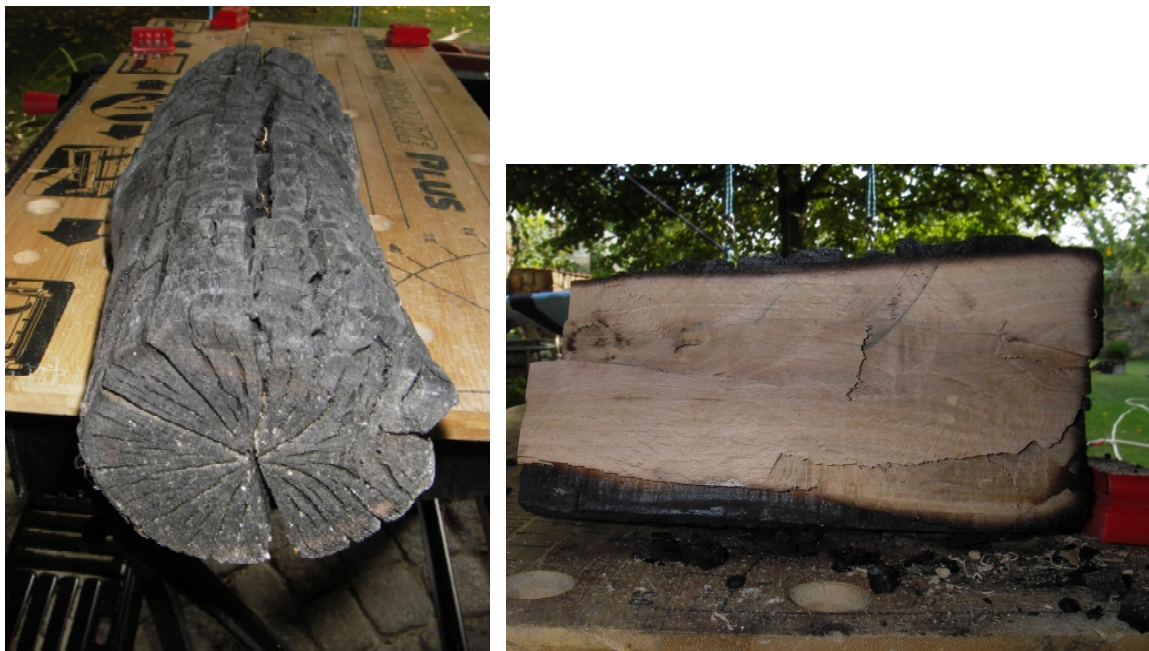
Abbildung 4.3: Kirschholz-Stamm nach 5 min. in intensivem Grillfeuer; links: von außen, rechts: aufgeschnitten
