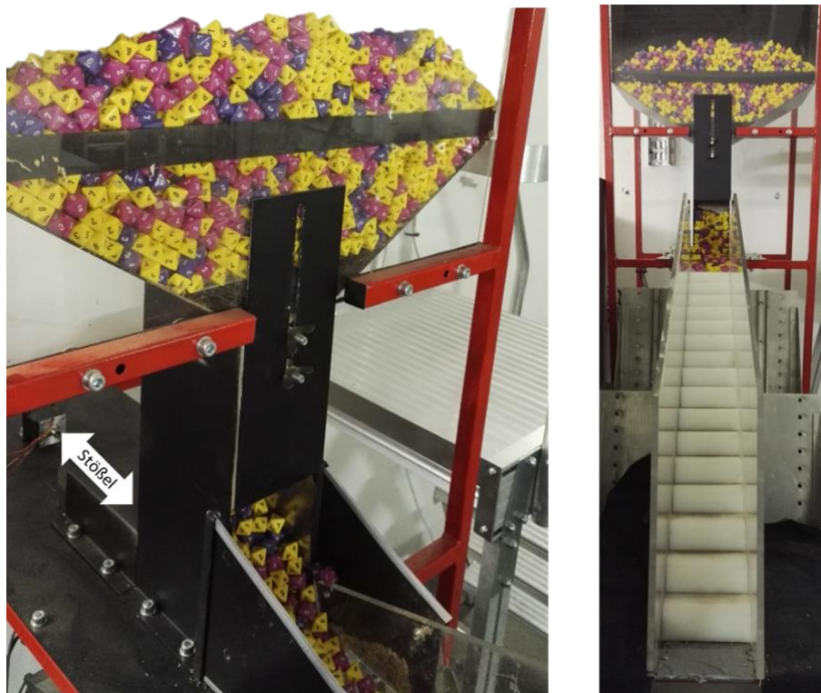
Abbildung II.68: Aufgabeschacht befüllt mit 8000 Oktaedern und angrenzendem Rostsystem
