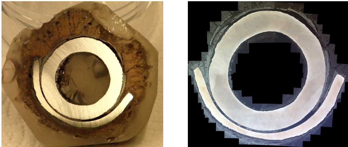
(a) Erstes Ergebnis nach Schleifen mit #400 Grit (b) Zusammengesetztes Bild aus Lichtmikroskopischen Aufnahmen (#4000 Grit) [10]
