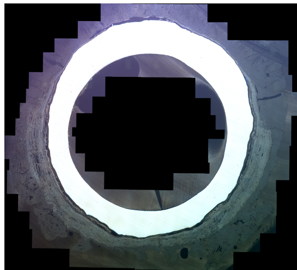
Abb. 2.7: Querschliff eines Überhitzerrohrs
