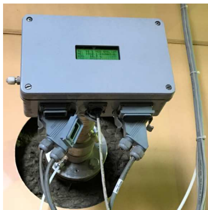
Abbildung 51: Anwendung der kombinierten HCl-H 2 O-Messung im GKS (linke Seite) und prinzipieller Aufbau der Messung (rechte Seite) [19]
