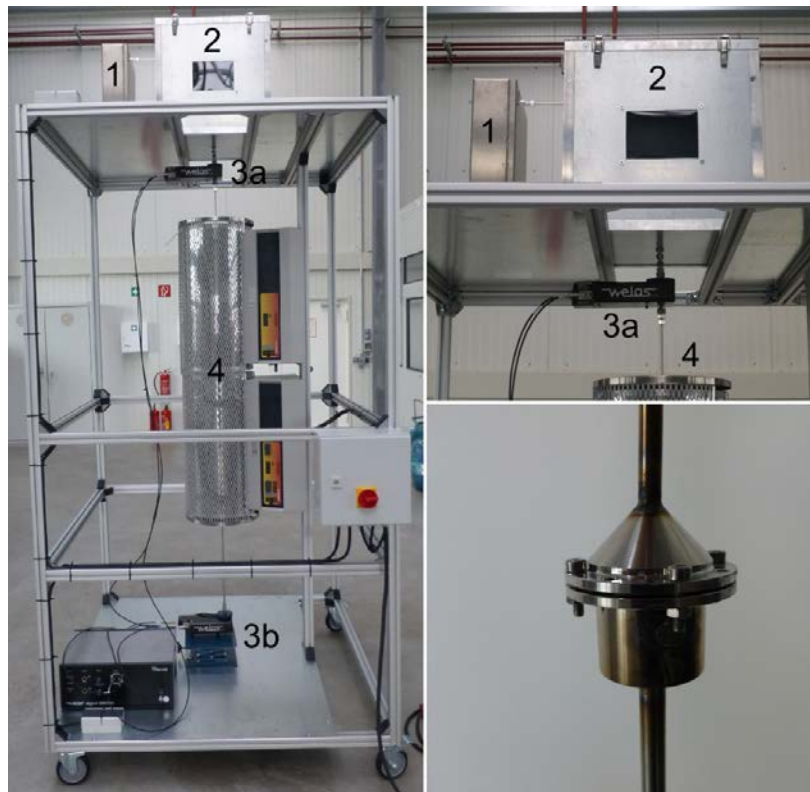
Abbildung 14: Versuchsaufbau zur Laborvalidierung der Probenahmesonde. (1) Bürstengenerator, (2) Box, (3a,b) Streulichtspektrometer, (4) Öfen. Rechts unten ist die Sonde mit angeschweißten Rohren gezeigt.
