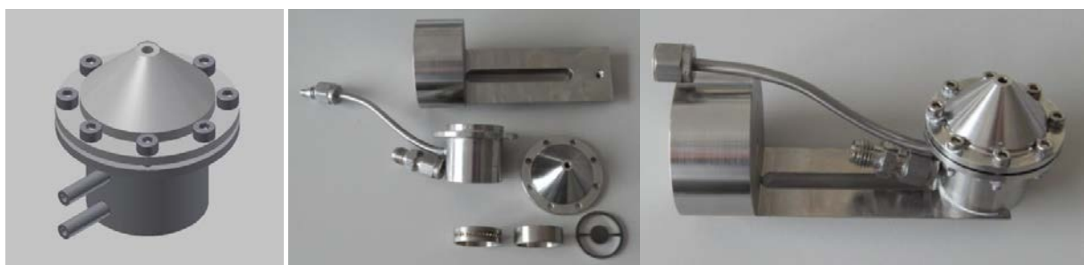
Abbildung 7: Neue Probenahmesonde. Links: 3D Bauteilzeichnung; Mitte: demontierte Sonde mit Halter; rechts: an Halter montierte Sonde.
