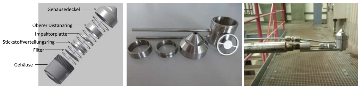
Abbildung 6: Explosionszeichnung der ausgelegten Sonde (links); demontierte Sonde (Mitte); an Lanze montierte Sonde beim Einsatz im GKS (rechts).
