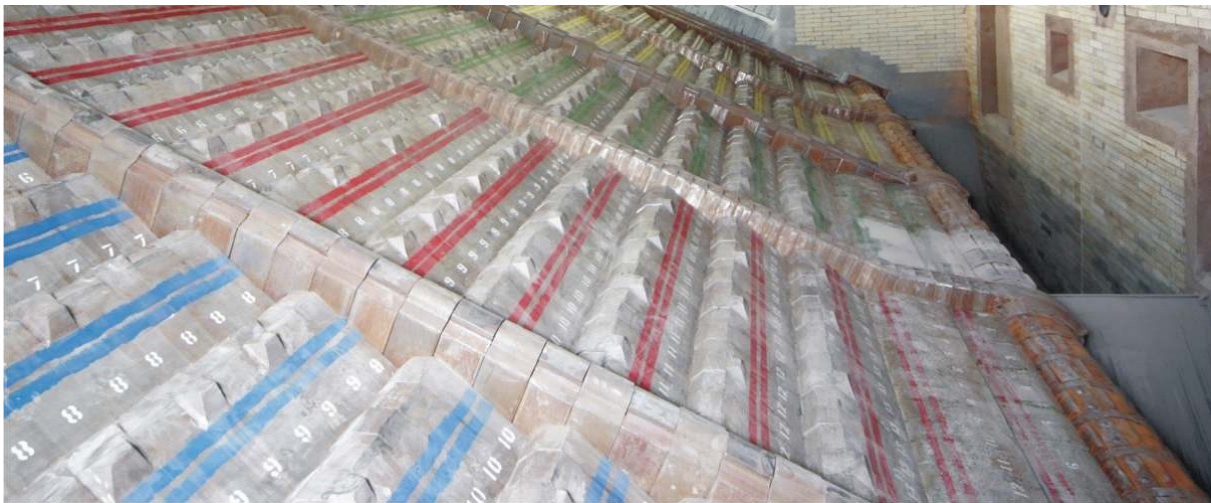
Abb. III-6: Rückschubrost der Firma Martin GmbH (genehmigt durch Martin GmbH)
