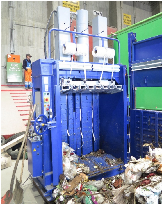
Abb. III-12: Portalpresse der Fa. Strautmann nach einem Pressversuch mit Brennstoff Hausmüll
