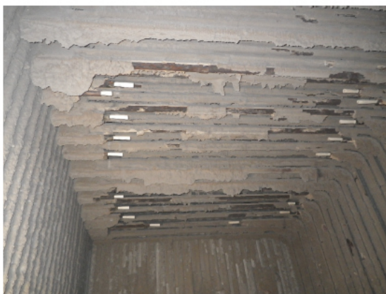
Abb. III-66: Beläge an Überhitzerpaket 6 im 3. Zug am GKS mit eingebauten Testrohren unterschiedlicher Werkstoffbeschichtungen nach einer Reisezeit von ca. 18 Monaten.
