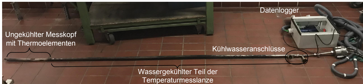
Abb. III-46: Hauptteile der Temperaturmesslanze
