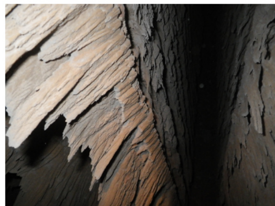
Abb. III-66: Beläge an Überhitzerpaket 6 im 3. Zug am GKS mit eingebauten Testrohren unterschiedlicher Werkstoffbeschichtungen nach einer Reisezeit von ca. 18 Monaten.
