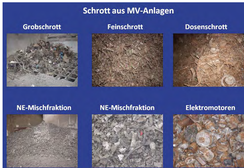
Abb.54: Unterschiedliche Schrottqualitäten wie sie mit derzeitigen konventionellen Aufbereitungsanlagen im Verlauf der Aufbereitung von MV-Schlacken gewonnen und in den Wertstoffkreislauf zurückgeführt werden.
