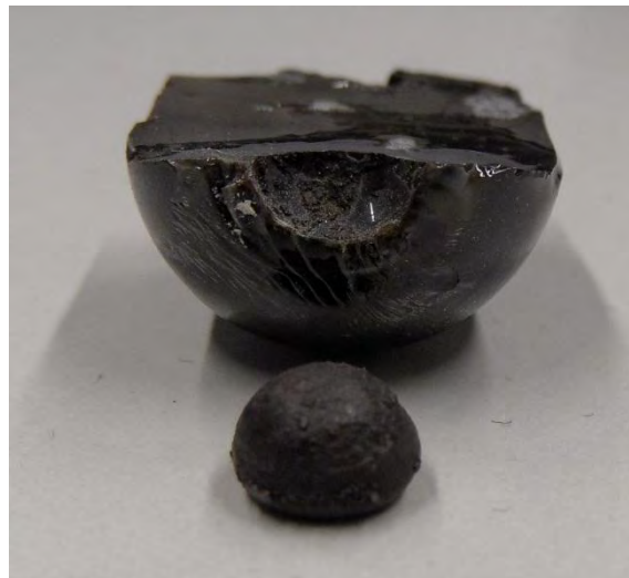
Abb.45: Abtrennung der Metalle durch Umschmelzen der Schlacke [3].
